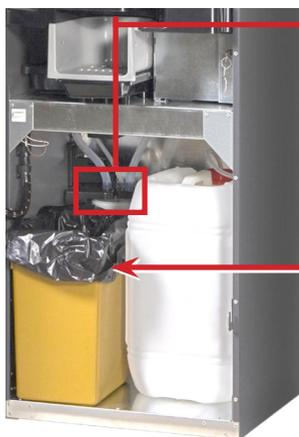
Шланг слива отходов и поплавков защиты от переполнения должны быть внутри канистры.
