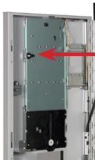
Защелка для доступа к кнопочной панели
