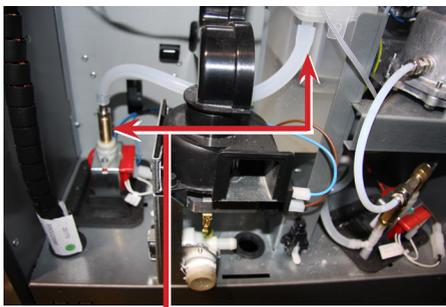
Снимите шланг с электроклапана к расширительному бачку и подключите его к выходу помпы.
