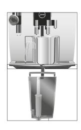
Промывка фильтра останавливается автоматически после того, как через фильтр пройдет примерно 300 мл жидкости.
