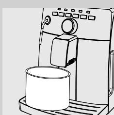
**5** Подставьте вместительную емкость (1,5 л) под трубку пара/горячей воды и под устройство подачи.
