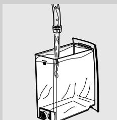
**2** Опорожните и хорошо прополоскайте бак для воды, наполните его до отметки уровня MAX и вставьте обратно в машину.
