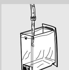
**4** Заполните бак свежей водой до уровня MAX. Вставьте бак для воды обратно в машину.
