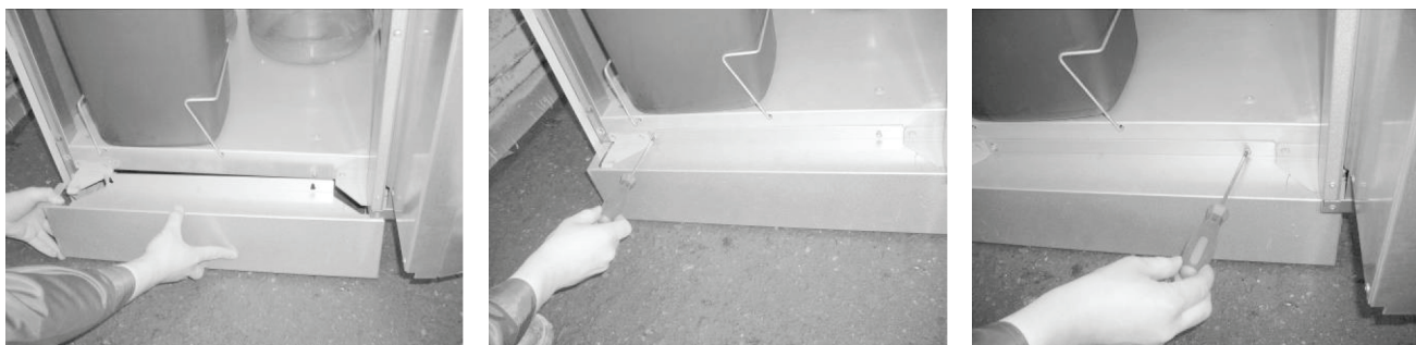
Рисунок 5.2 - Установка нижнего бампера
